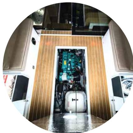
Il motore, un Volvo da 75 cv con sail drive, è accessibile tramite un portellone al centro del pozzetto.
