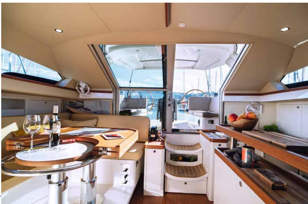
Sotto, la piattaforma dove poggia il divano si inclina elettricamente di 10° in alto e in basso per contrastare lo sbandamento. È tutta di carbonio e pesa meno di 50 kg. Carteggio e quadro elettrico sono ai lati del passaggio verso la zona notte.
