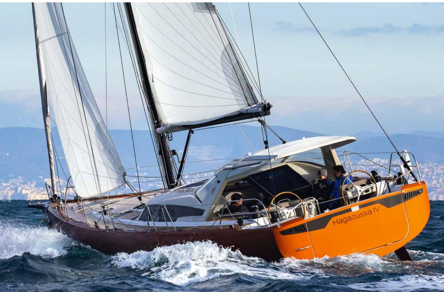
Lo yacht è costruito in sandwich con anima di San/Pvc e fibre miste di vetroresina e carbonio e infusione di resina vinilestere o epossidica a seconda della zona. Tutte le paratie sono in composito. Per le appendici il cantiere ha scelto una tandem keel con pescaggio di 2,30 metri e una coppa di timoni. Nella foto non c'è nessuno al timone: l'idea è di affidare all'autopilota la conduzione della barca nella maggior parte dei casi.
